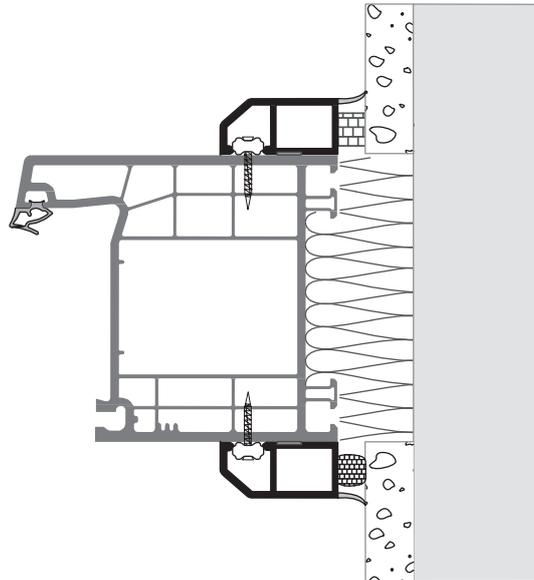
**Anschlussdichtprofil, klipsbar für den Innenbereich:**
