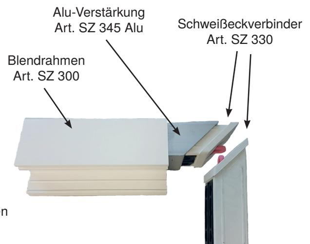
Zur Herstellung einer kraftschlüssigen Verbindung des Torrahmens, werden die Schweißbeckverbinder Art. SZ 330 in die Verstärkung Art. SZ 345 des Torrahmens eingeschoben und fest verkeilt.
